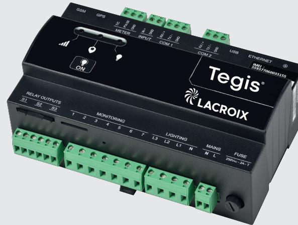
L'unité de contrôle Tegis vient se positionner dans l'armoire EP pour permettre la gestion intelligente de celle-ci.
